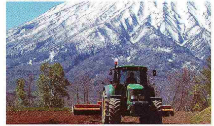
▲写真7 自動操舵を装着したトラクタ
