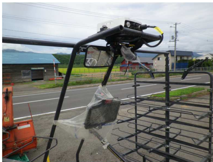
写真2 衛星電波の受信部(上部)とモニター(下部)
