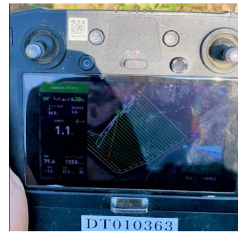
写真16 ドローンのコントローラー (散布経路と散布状況が画面に表示される)
