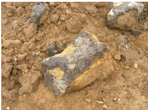
客土材に石混入状況
