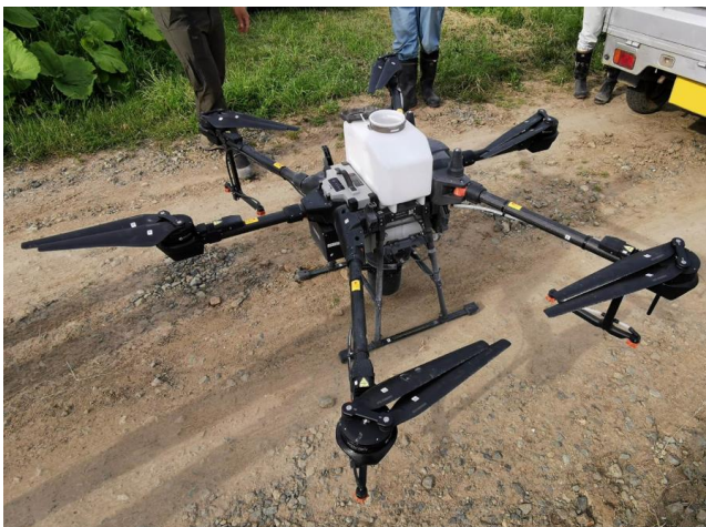
写真9 散布作業の効率化のため、大型ドローンを使用
