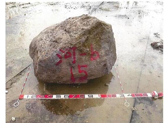
調査箇所を確認された岩塊 (約1300mm×1000mm×800mm、約2500kg)
