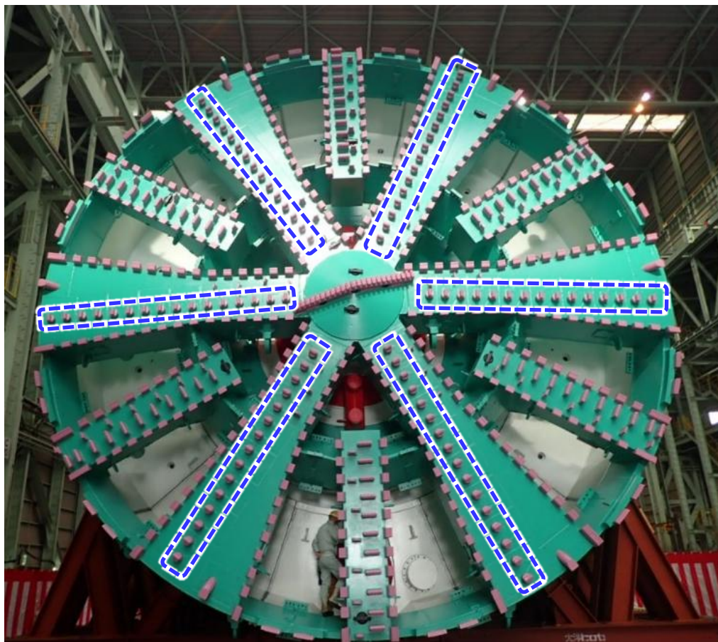
● : 交換式先行ビット ● : 機内から交換できないビット
