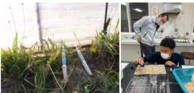
信頼性の高い科学的根拠（エビデンス）を作出・蓄積するため、様々なデータを採取・解析して本消毒法の効果を検証（処理期間中、土壌中に生成される二価鉄、二価マンガンと揮発性有機酸の生成量を測定する様子）
