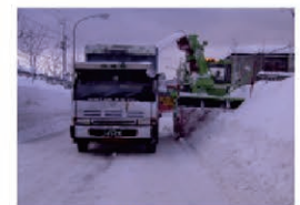
運搬排雪状況
