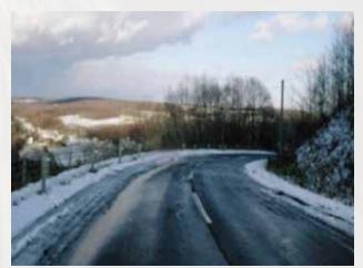
山間部の斜面による日陰部分が凍結路面となっています。
